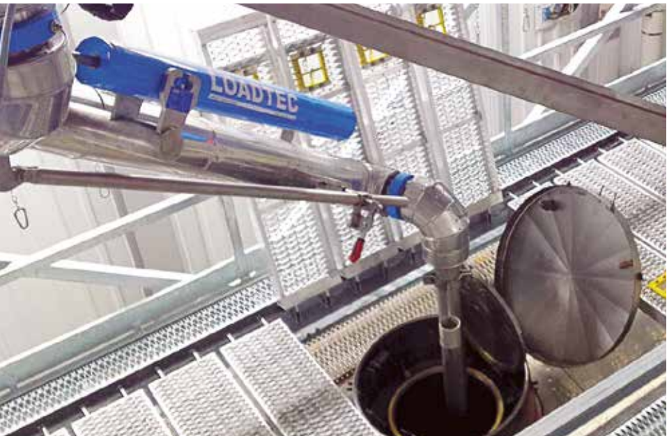
Brazo de carga superior calentado de 4" para aceite de cocina - UK - Food Industry
