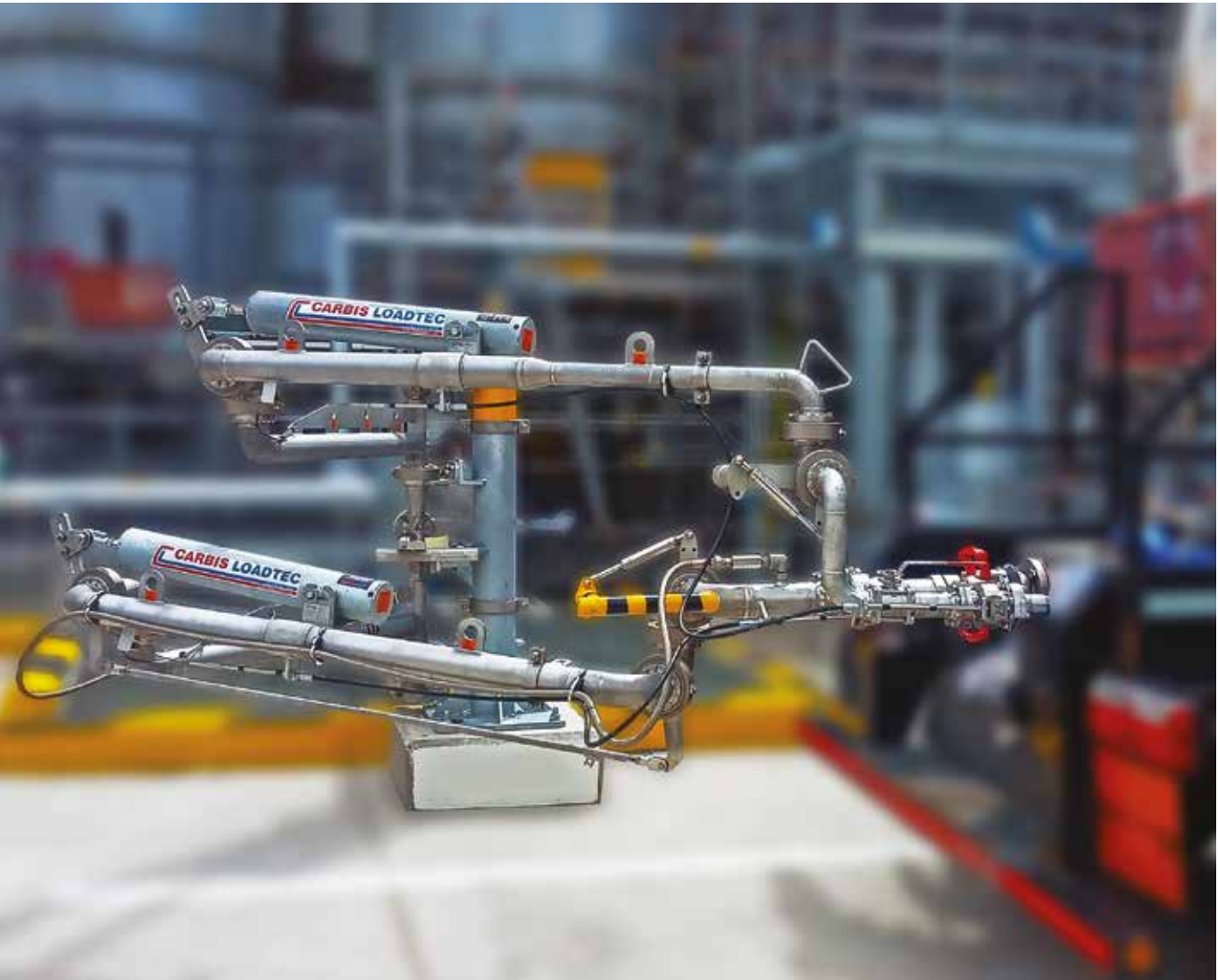
LA450 Estación de carga inferior con brazo de vapor
