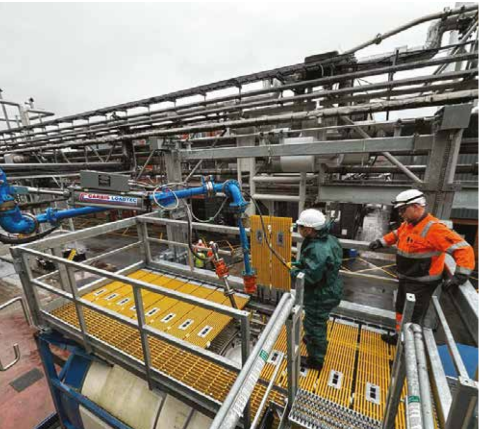
Brazo de carga revestido de PTFE sobre plataforma de elevación vertical
