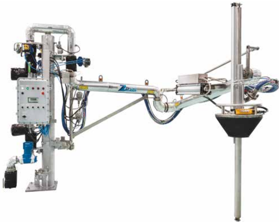
Plataforma de dosificación montada en poste con válvulas de control y brazo de carga superior de acero inoxidable 904L de 3" con equilibrio neumático, tubo de caída telescópico, retorno de vapor, traceado eléctrico y aislamiento - España - Farmacia
